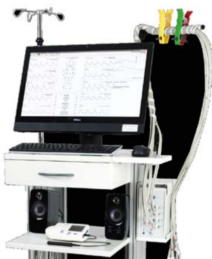
Рисунок 24. Внешний вид ангиографической станции «AngE ANGIOLOGIC» и отчет проведенного исследования.
