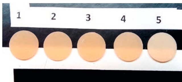
Рисунок 2. Образцы композита толщиной 1,0 \pm 0,1 мм диаметром 10,0 \pm 0,1 мм на контрастной подложке: 1) композит «Реставрин» А3 без АМД; 2) композит с 0,001 % АМД; 3) композит с 0,010 % АМД; 4) композит с 0,50 % АМД; 5) композит с 5,00 % АМД.
