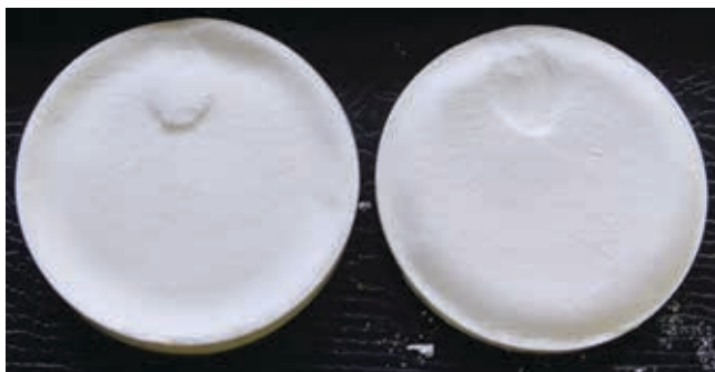
Рисунок 2. Образец, полученный после прессования при давлении 240 МПа
