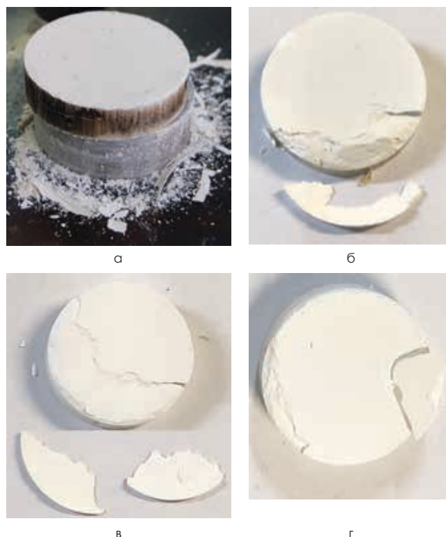
Рисунок 3. Образец после извлечения из матрицы (а) и бракованные образцы после прессования при давлении: 200 МПа (б), 175 МПа (в), 120 МПа (г)
