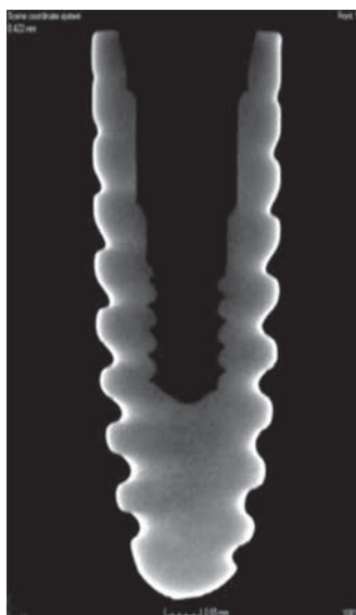
Рисунок 11. Трехмерная реконструкция рентгеновской томографии напечатанного методом стереолитографии имплантата из 3Y-TZP
