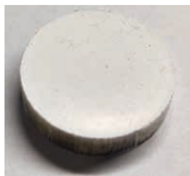
Рисунок 4. Образец после прессования при давлении 150 МПа
