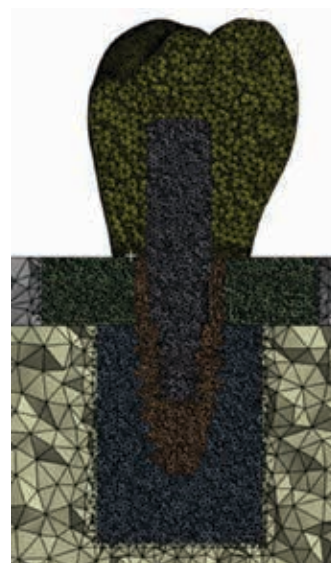
Рисунок 2. Сеточная модель исследуемой системы
