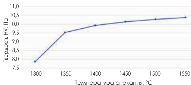
Рисунок 7. Зависимость твердости по Виккерсу от температуры после свободного спекания образцов
