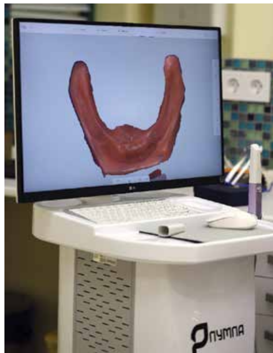
Рисунок 1. Интраоральный сканер «Пумпа»
