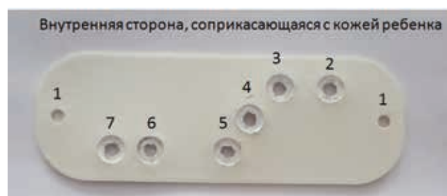
Рисунок 1. Пластина для фиксации грудных электродов. 1 – отверстия для фиксаторов, 2 – отверстие для крепления электрода для регистрации V1 грудного отведения, 3 – отверстие для крепления электрода для регистрации V2 грудного отведения, 4 – отверстие для крепления электрода для регистрации V3 грудного отведения, 5 – отверстие для крепления электрода для регистрации V4 грудного отведения, 6 – отверстие для крепления электрода для регистрации V5 грудного отведения, 7 – отверстие для крепления электрода для регистрации V6 грудного отведения
