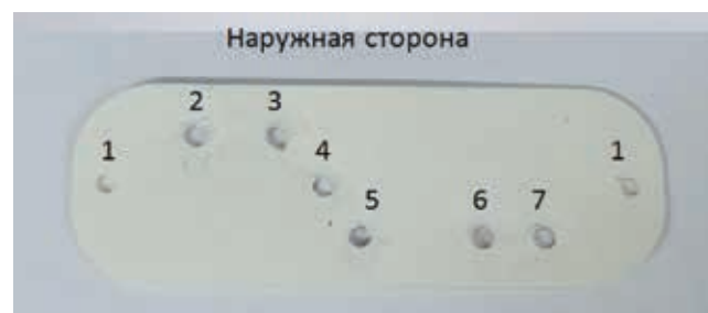
Рисунок 1. Пластина для фиксации грудных электродов. 1 – отверстия для фиксаторов, 2 – отверстие для крепления электрода для регистрации V1 грудного отведения, 3 – отверстие для крепления электрода для регистрации V2 грудного отведения, 4 – отверстие для крепления электрода для регистрации V3 грудного отведения, 5 – отверстие для крепления электрода для регистрации V4 грудного отведения, 6 – отверстие для крепления электрода для регистрации V5 грудного отведения, 7 – отверстие для крепления электрода для регистрации V6 грудного отведения
