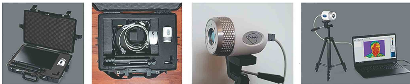
Рисунок 2. Тепловизор «ТВС300-мед» производства ООО «СТК СИЛАР» (г. Санкт-Петербург): а) транспортировочное состояние, б) комплектация, в) тепловизор; г) рабочее состояние для проведения исследований
