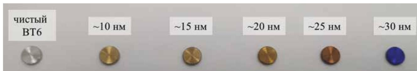
Рисунок 1. Внешний вид образцов пленок диоксида титана на поверхности титановых имплантатов
