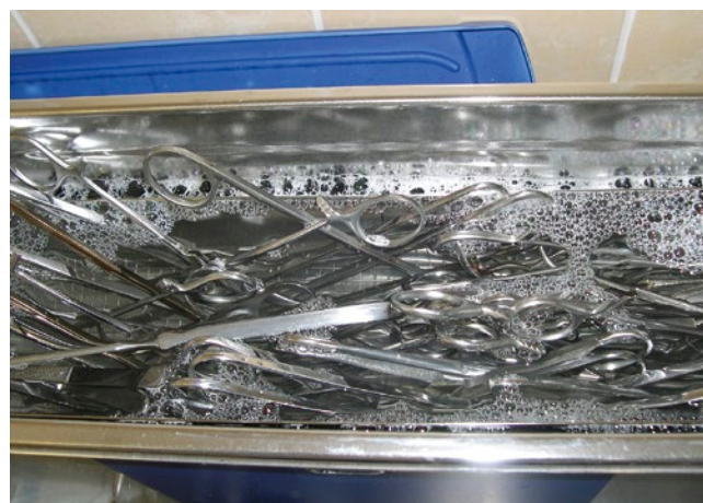
Рисунок 9. Перегруженный УЗ-очиститель. Инструменты не покрыты водой.
