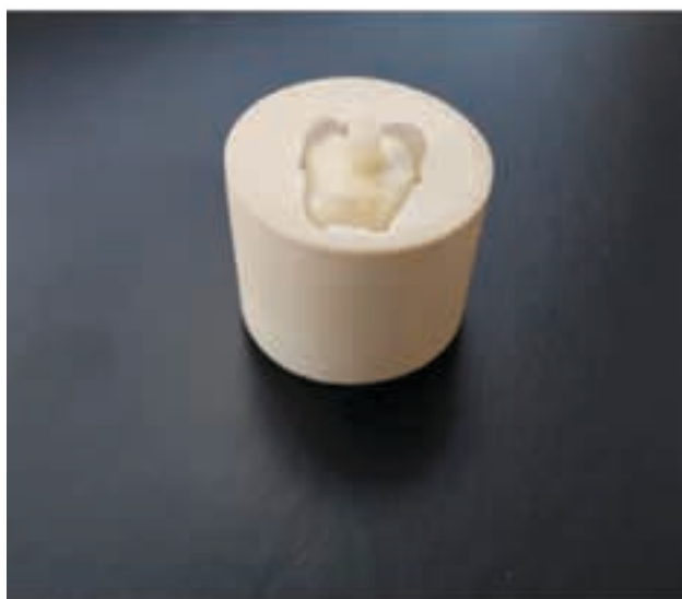
Рисунок 1. Образец для испытания. Срез зуба в сагитальной плоскости в блоке самотвердеющей пластмассы
