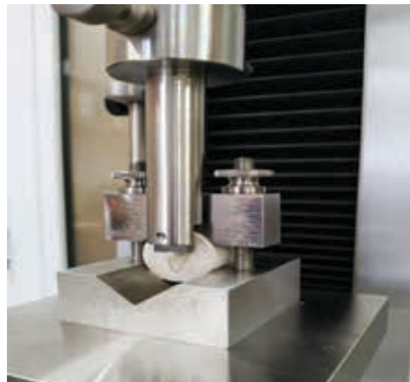
Рисунок 2. Испытания адгезионной прочности образцов на сдвиг на универсальной испытательной машине SYNTHES 5
