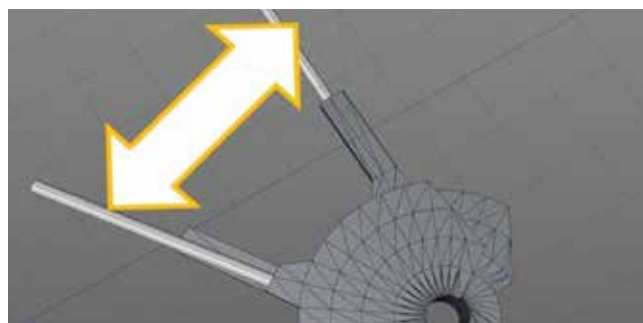
Рисунок 8. Регулировка угла, формируемого при пересечении спиц, в плоскости, перпендикулярной штифту
