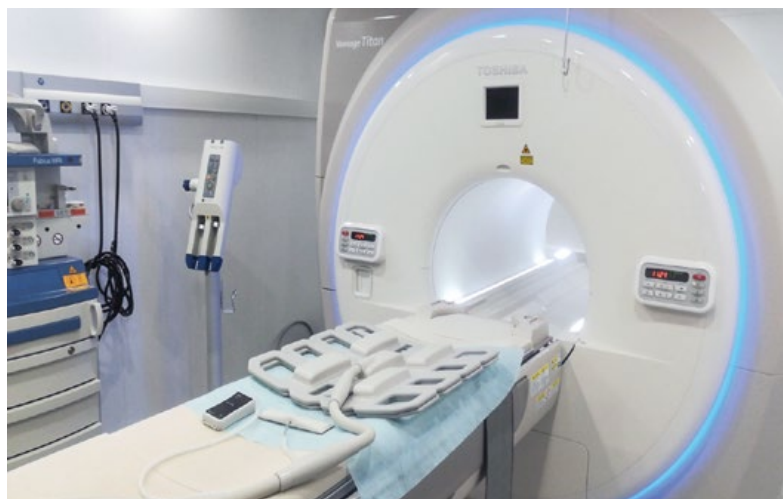
Рисунок 2. Общий вид и оснащение МР-томографа для проведения процедуры ASL-перфузии печени.
