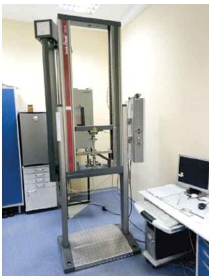
Рисунок 1. Универсальная испытательная машина Zwick Roell Z010 и персональный компьютер с программным обеспечением TestXpert.
