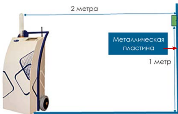
Рисунок 1. Схема облучения тест-объекта установкой «Альфа-06».
