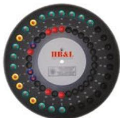
Запатентованная технология, основанная на методе **лазерного светорассеяния**, позволяет обнаружить с **высокой чувствительностью и специфичностью** наличие бактерий в пробе и определить их чувствительность к антибиотикам.
