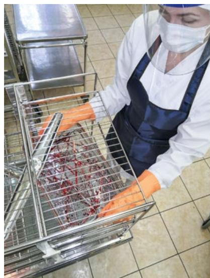
Рисунок 4. Загрузка стеллажа с МИ в моюще-дезинфицирующую машину.
