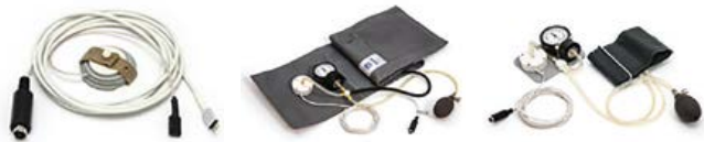
Рисунок 4. Комплект датчиков для сфигмографии прибора «Поли-Спектр-СРПВ»: датчик артериального пульса ДАП-1 (с кабелем и лентой); датчик на бедро (с манжетой, манометром и нагнетательной грушей) для регистрации объемной сфигмограммы; датчик на запястье (с манжетой, манометром и нагнетательной грушей) для регистрации объемной сфигмограммы.
