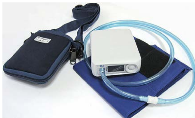
Рисунок 7. Монитор «BPLab» ООО «Петр Телегин», совмещающий функционал СМАД и объемного сфигмографа с контурным анализом.
