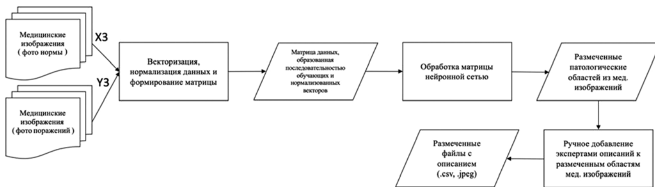
Рисунок 14. Схема процесса обучения нейронной сети разметке патологических областей, отличных от нормы (X3 — фотоизображения нормы СОР, Y3— фотоизображения патологии СОР).
