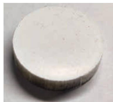
Рисунок 4. Образец после прессования при давлении 150 Мпа
