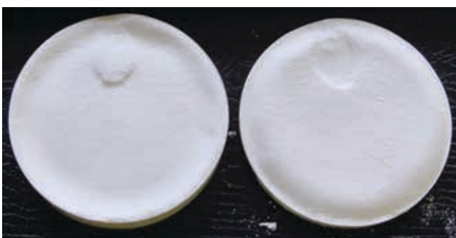
Рисунок 2. Образец, полученный после прессования при давлении 240 Мпа
