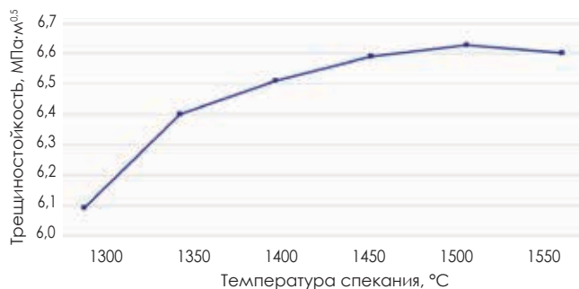
Рисунок 9. Зависимость трещиностойкости от температуры после свободного спекания образцов
