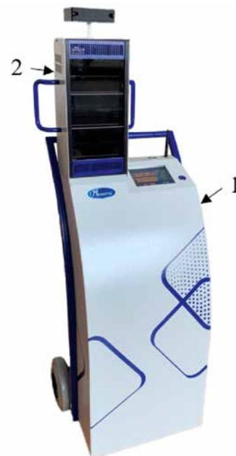
1 – Установка импульсная ультрафиолетовая передвижная для обеззараживания воздуха и поверхностей помещений «Альфа-06А» (ООО «НПП «Мелитта», Россия); 2 – Устройство формирования потока УФ-излучения в ограниченном телесном угле «Ареал». Рисунок 1. Общий вид импульсной ультрафиолетовой системы «Альфа-06А»
