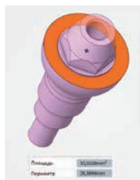
Рисунок 4. А – трехмерная модель КС. Оранжевым цветом выделена контактная поверхность площадью 10,5 мм 2 , на которую опирается абатмента конической супраструктуры; Б – фиксирующий винт для КС диаметром головки 2,15 мм, диаметр резьбы 1,206 мм, площадь контактной поверхности 1,8634 мм 2
