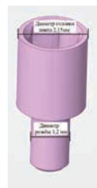
Рисунок 4. А – трехмерная модель КС. Оранжевым цветом выделена контактная поверхность площадью 10,5 мм 2 , на которую опирается абатмента конической супраструктуры; Б – фиксирующий винт для КС диаметром головки 2,15 мм, диаметр резьбы 1,206 мм, площадь контактной поверхности 1,8634 мм 2
