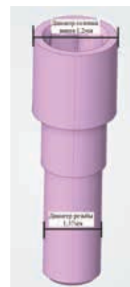
Рисунок 3. А – трехмерная модель ПС. Оранжевым цветом выделена контактная поверхность площадью 9,4 мм 2 , на которую опирается абатмента плоской супраструктуры; Б – фиксирующий винт для ПС диаметром головки 2 мм, диаметр резьбы 1,372 мм, площадь контактной поверхности 1,2547 мм 2
