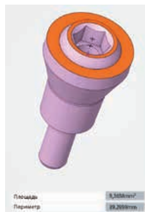
Рисунок 3. А – трехмерная модель ПС. Оранжевым цветом выделена контактная поверхность площадью 9,4 мм 2 , на которую опирается абатмента плоской супраструктуры; Б – фиксирующий винт для ПС диаметром головки 2 мм, диаметр резьбы 1,372 мм, площадь контактной поверхности 1,2547 мм 2
