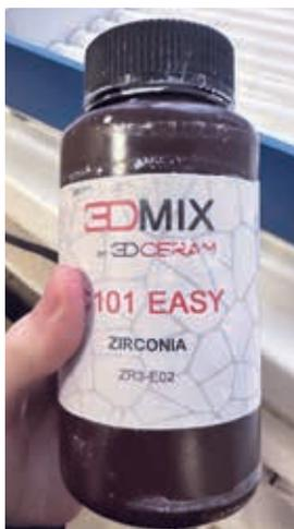
Рисунок 1. Внешний вид тары с керамической суспензией 3D Ceram (Франция)
