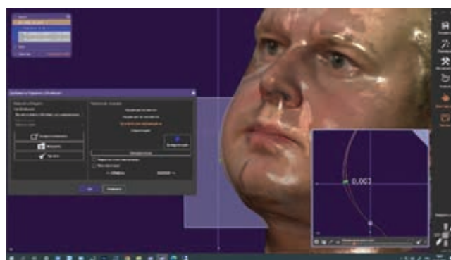
Рисунок 4. Работа с STL: а – объединение STL по дням; б – вычисление разницы объемов по дням
