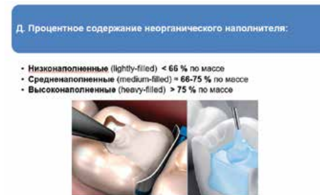
Рисунок 6. Современная классификация композитных реставрационных материалов. Д. Процентное содержание неорганического наполнителя
