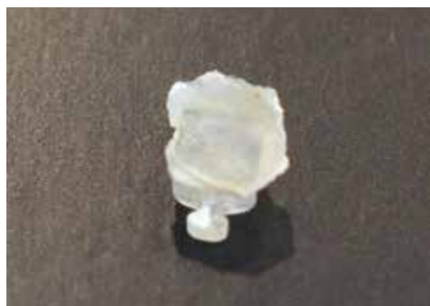
Рисунок 5. Разрушение по границе контакта фиксирующего брекет материала и эмали зуба
