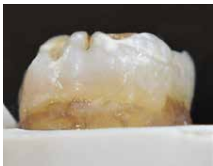
Рисунок 5. Разрушение по границе контакта фиксирующего брекет материала и эмали зуба
