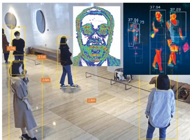
Рисунок. Результаты, получаемые с помощью различных современных систем биометрической видеоаналитики: оценка социальной дистанции, регистрация мимики с помощью виброизображения, измерение температуры кожи с помощью инфракрасной съемки).
