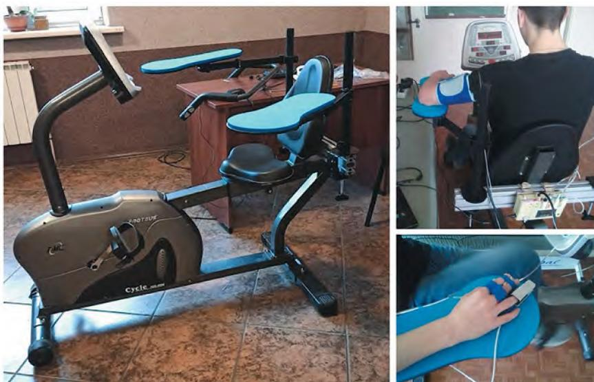
Рисунок 2. Велоэргометр с регулируемыми подставками для рук. Испытуемому предлагалось выполнить пробу по следующему протоколу:
