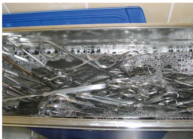
Рисунок 9. Перегруженный УЗ-очиститель. Инструменты не покрыты водой.
