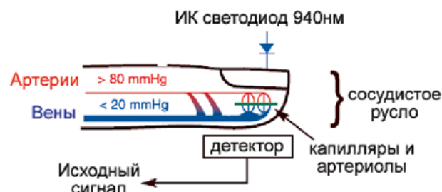
Рисунок 1. Схематическое изображение оптического сенсора пульсоксиметра, установленного на концевой фаланге пальца. Инфракрасное излучение проходит через всю толщину пальца и регистрируется с помощью фотодетектора, который преобразует свет в напряжение (преобразователь «свет – напряжение») или частоту (преобразователь «свет – частота»).
