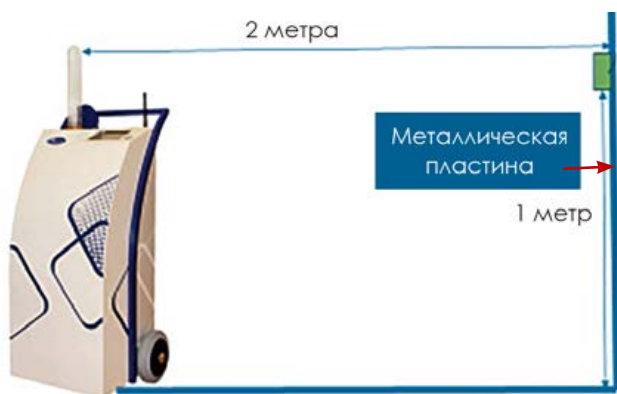
Рисунок 1. Схема облучения тест-объекта установкой «Альфа-06».
