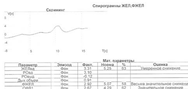
Рисунок 5. Пример исследования, когда не установлен 0 потока (дыхание начато раньше установки изолинии), кривая спирограммы в координатах объем–время направлена вверх, полученные данные занижены.
